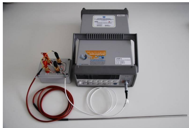
Slika 2: Termometer Elpro 2210 in prikazovalnik HP 34420A.
