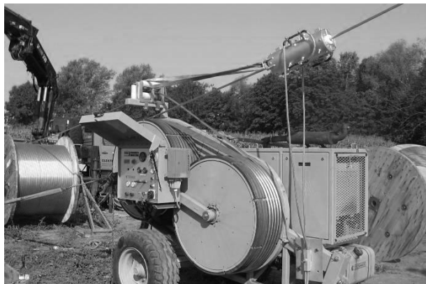
Slika 6: Preskus vlečenja vodnika skozi drsno ozemljitveno sponko
