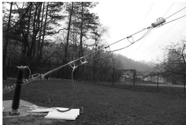
Slika 10: Kapacitivni delilnik za merjenje preostale napetosti
