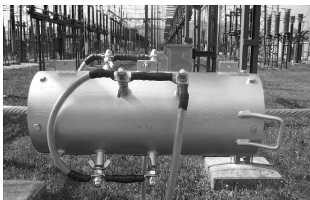
Slika 4: Drsna sponka za ozemljevanje vodnikov daljnovoda
