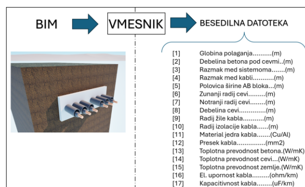
Slika 4: Izmenjava podatkov med BIM in FreeFEM.
