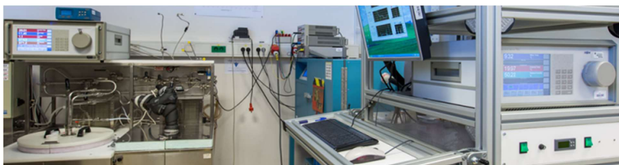
Slika 2: Merilna oprema LMK, ki je bila uporabljena pri primerjavi. Od desne proti levi: merilnik rosišča MBW 373H, zadaj generator Thunder Sc. 2500 in levo primarni generator rosišča.
