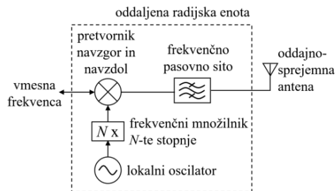
Slika 2: Prikaz zgradbe oddaljene radijske enote.
