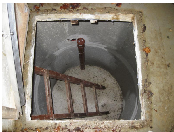
Slika 1: Antena sprejemnika ELF na observatoriju v jaški, globokem 2 m
