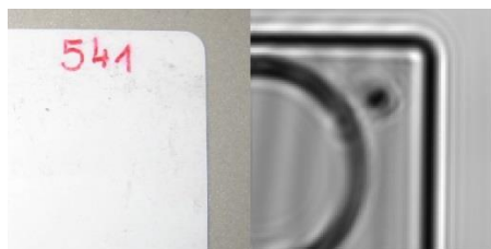
Slika 12: Slikovni rezultat presvetlitve RFID-kartice s THz-valovanjem
