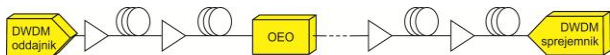
Slika 1: Visoko spektralno učinkovit sistem na standardnem enorodovnem vlaknu, ki uporablja regeneratore OEO
