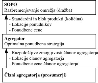
Slika 4: Vloga agregatorja pri razbremenjevanju omrežja.
