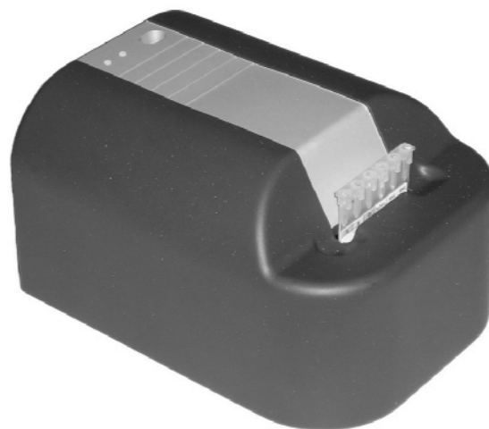
Slika 5: Naprava za zajem slik gelskih kartic Figure 5. Device for capturing gel card images.
