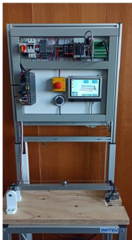
Slika 15: Realni sistem za regulacijo ravnovesja krogle na letvi.
