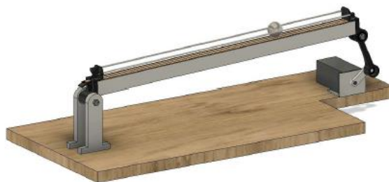
Slika 7: 3D-model sistema za regulacijo ravnovesja kroglice na letvi.
