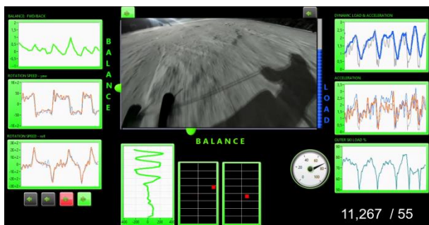
Slika 7: Razširjeno aplikacijsko okno za analizo videoposnetka vožnje in časovnih potekov smučarsko specifičnih signalov, ki so povezani z izmerjenimi signali iz senzorjev sile, pospeškometrov in žiroskopov.
