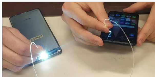
Slika 7: Komunikacija med pametnimi telefoni s pomočjo optičnega vlakna.
