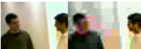
Slika 6: Vpliv kvantizacijske stopnice na kakovost digitalnega videa pri uporabi DCT s Q = 10 (levo) in Q = 200 (desno)
