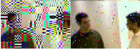
Slika 11: Vpliv šumnega AWGN-kanala z vrednostjo SNR = 5 dB na kakovost digitalnega videa z uporabo kodeka DCT (levo) in kodeka DWT (desno)
