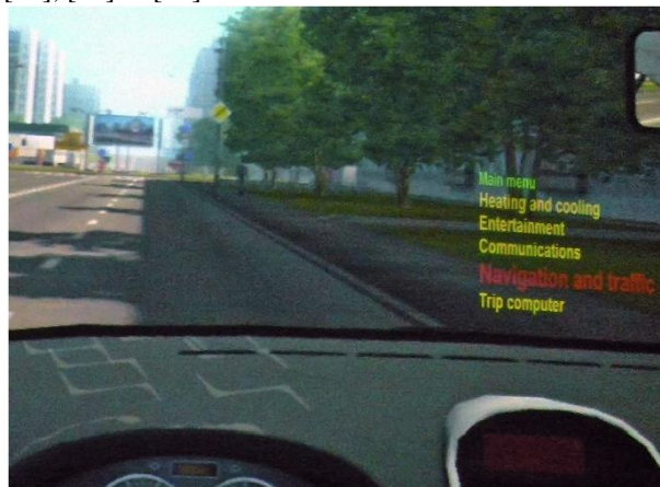
Slika 2. Prikazovanje informacij na vetrobranskem steklu ( Head-up display ) [14].
