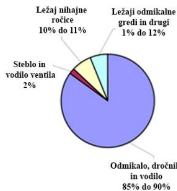
Slika 6: Primer razdelitve izgub pogona ventilov pri večjem dizelskem motorju z zgornjim krmiljenjem ventilov [22]
