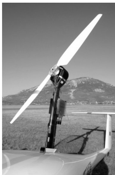
Slika 2: Pogonski del letala Taurus Electro
