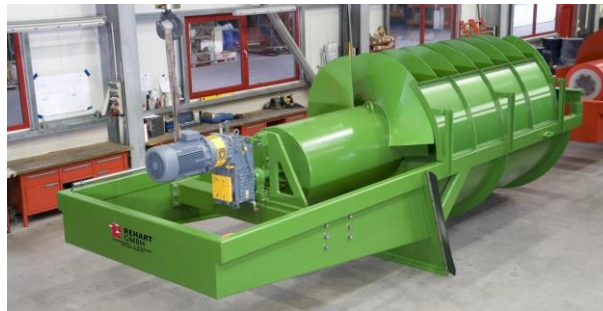
Slika 1: Kompaktni postroj MHE z Arhimedovim vijakom
