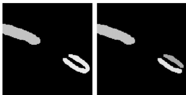
Slika 4. Mogoča rezultata postopka iskanja povezanih komponent Figure 4. Possible results of the connected-component labeling procedure
