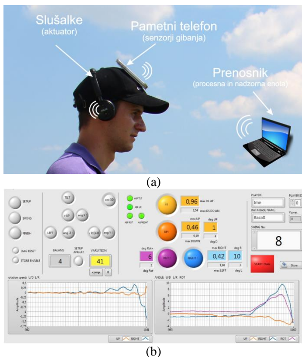
Slika 7: Testna aplikacija Golf asistent: (a) konfiguracija opreme, (b) okno za prikaz rezultatov analize golfskega zamaha
